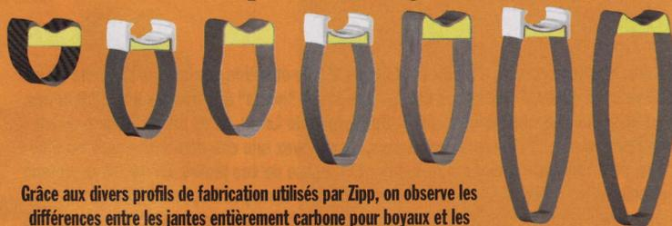
Grâce aux divers profils de fabrication utilisés par Zipp, on observe les différences entre les jantes entièrement carbone pour boyaux et les jantes mixant alu et carbone destinées à recevoir un pneu. On en déduit les différences de poids entre les deux types de jantes.
