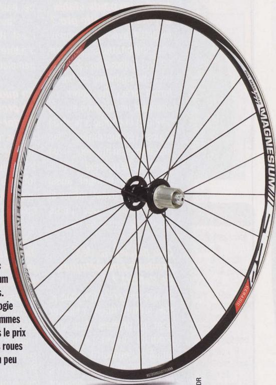
FSA sort le grand jeu avec les 1440 : jantes magnésium et roulements céramiques. Une débauche de technologie pour gagner quelques grammes sans perdre de watt. Mais le prix se rapproche de celui des roues carbone à boyaux avec un peu plus de poids.
