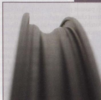
La jante tubeless est assez creuse, ce peut être un moyen de gagner du poids. La jante à boyau est plus arrondie, alors que la jante à pneu nécessite toujours un ruban de jante qui alourdit d'autant les jantes percées.
