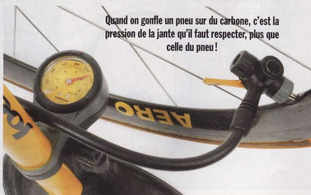
Quand on gonfle un pneu sur du carbone, c'est la pression de la jante qu'il faut respecter, plus que celle du pneu!
